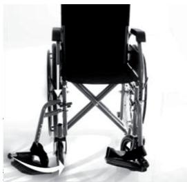
Per installare i poggiapiedi, allineare i fori dei supporti con i relativi perni sul telaio della carrozzina, quindi ruotare il poggiapiedi verso l'interno agganciando correttamente la leva di bloccaggio al telaio della carrozzina.
