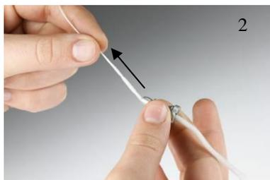
Dopo aver pulito accuratamente i canali, è necessario montare la sonda. Infilare la punta della sonda nel corpo principale, facendo attenzione di allineare la guida A, situata nel corpo, con il foro B presente nella punta, come indicato nella figura sottostante. Avvitare quindi la ghiera.
