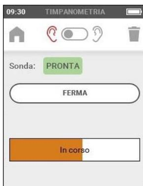
Nel caso in cui vi siano delle perdite di pressione, lo strumento tenta di eseguire la scansione in pressione fino a tre volte prima di evidenziare il problema. In caso di impossibilità di esecuzione dell'esame a causa di perdita di pressione, provare a sostituire il peduncolo con uno di dimensione differente e/o provare a variare la posizione e la direzione della sonda all'interno del canale uditivo.
