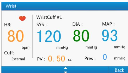
Figura 21 Interfaccia di simulazione della BP al polso
