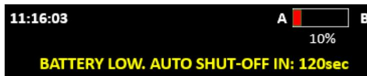
Collegare il defibrillatore alla corrente di rete AC per avviare la ricarica della batteria e continuare a usare il defibrillatore.
