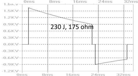
Per un valore di impedenza di 40 ohm o meno, l'energia massima è 150 J. Se l'energia è impostata su un valore superiore a 150 J, il dispositivo imposterà automaticamente l'energia a 150 J. Per valori di impedenza diversi da 50 ohm, l'accuratezza dell'energia erogata è +/- 15%. Per un'impedenza di 50 ohm l'accuratezza è +/- 10%.
