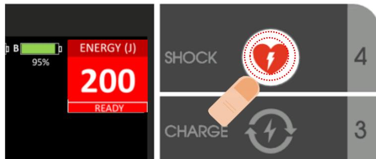
Se il PULSANTE SHOCK non viene premuto entro 15 secondi avviene automaticamente la SCARICA INTERNA.
