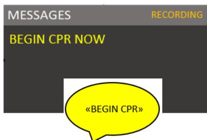
Il metronomo da 100 compressioni al minuto funge da guida audio per l'operatore. Dopo 2 minuti, si ferma e ricomincia un nuovo ciclo di analisi ECG (vedere punto 1).
