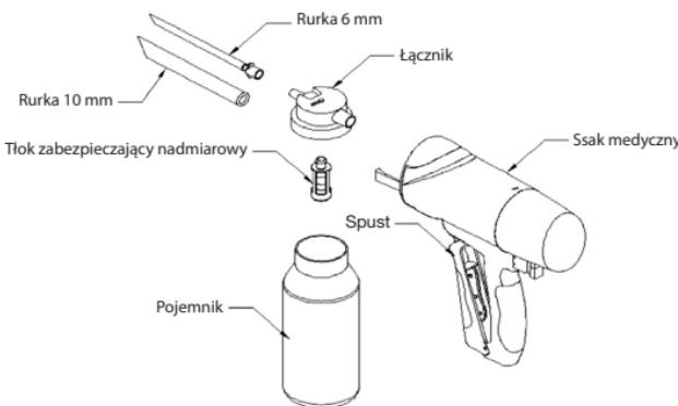
2. Podłączyć łącznik z rurką do pokrywy pojemnika. Pojemnik powinien być dołączony do pompki.
