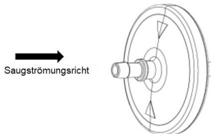
Sicherstellen, dass der Filter so angebracht ist, dass sich die Pfeile auf der Seite des Patienten befinden.
