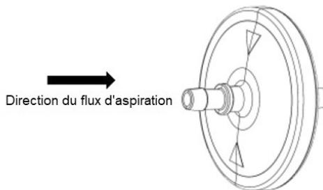
**S'assurer que le filtre soit monté avec les flèches sur le côté du patient.**
