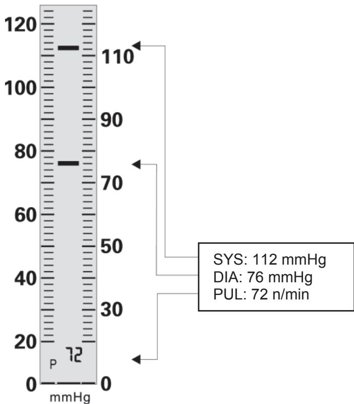
5. عند نهاية النفخ، يفتح صمام التفليس تلقائياً، ويتم تفريغ الهواء ببطء وينخفض الضغط. ويبدأ الجهاز تلقائياً في الكشف عن ضغط الدم ومعدل ضربات القلب.
