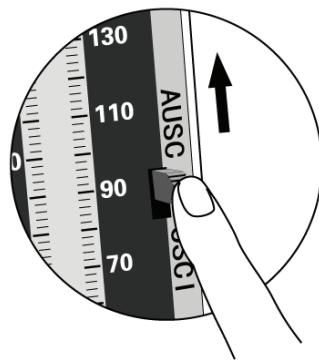
1. Ρυθμίστε τον επιλογέα λειτουργίας στην επάνω θέση (AUSC) για να επιλέξετε τη μέθοδο μέτρησης με ακρόαση.
