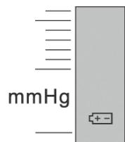
\* Wenn auf dem LCD-Display das in der Abbildung angegebene Symbol erscheint, sind die Batterien leer und das Blutdruckmessgerät funktioniert nicht mehr. Die beiden verbrauchten AA-Alkalibatterien durch zwei neue ersetzen.
