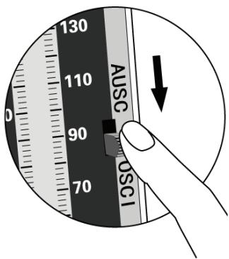
1. Coloque el selector de modalidad en posición bajo (OSCI) para seleccionar el método de medición oscilográfico.
