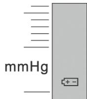
\* Quando o visor a LCD mostra o símbolo ilustrado ao lado, quer dizer que as pilhas estão descarregadas e que o esfigmomanômetro não pode funcionar, substituir as pilhas alcalinas “AA” velhas com duas novas.
