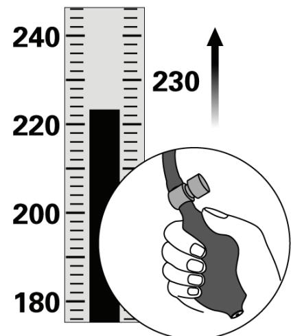
4. Cierre la válvula de escape e hinche la pulsera con la bomba. Cuando el indicador alcance un valor superior a, aproximadamente, 2.5~4.0 kPa (18.75~30 mmHg) en relación a la presión sistólica normalmente detectada, puede parar de hinchar el brazalete.
