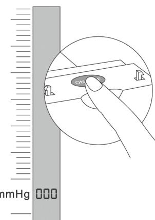
2. Pressionar a tecla “ON/OFF”, depois da sequência de partida, a tela visualizará “000” e a escala LCD em zero. O aparelho tem uma função de autodiagnóstico, se for detectado ar residual na braçadeira, é visualizado o caractere “P” intermitente. Depois de eliminados os resíduos de ar, na tela aparecerá “000”.
