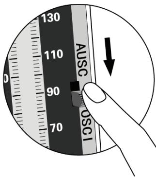
1. Stellen Sie den Schalter zur Auswahl des Betriebsmodus nach unten (OSCI), um die oszillographische Messmethode auszuwählen.
