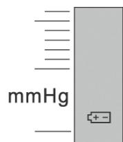
\* Cuando el display de LCD visualiza el símbolo de la figura, significa que las pilas están agotadas y el esfigmomanómetro no puede funcionar, sustituir las pilas alcalinas tipo "AA" con dos nuevas.
