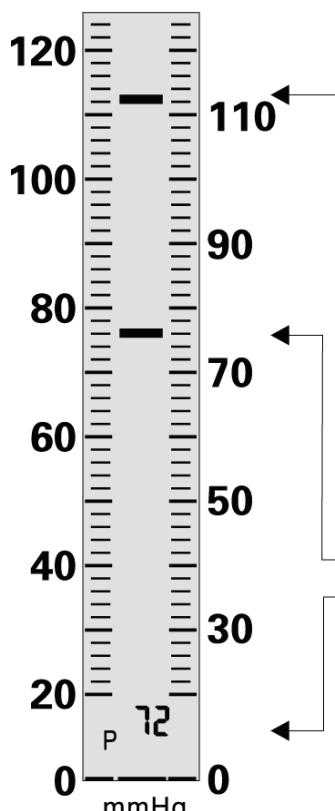
5. No final da insuflação automaticamente abre-se a válvula de alívio, o ar é liberado lentamente e a pressão diminui. O dispositivo inicia a detectar a pressão sanguínea e o batimento cardíaco automaticamente.
