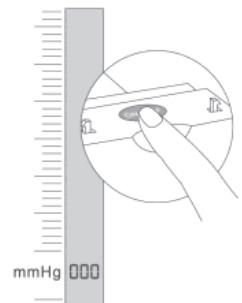
2. اضغط على زر "ON / OFF" بعد سلسلة خطوات بدء التشغيل، وسوف تعرض الشاشة "000" ويكون مقياس LCD عند الصفر. ويتمتع الجهاز بخاصية التشخيص الذاتي: وعند وجود هواء متبقى في معصم الجهاز، فإن الحرف "P" يظهر ويومض. وبعد التخلص من الهواء المتبقى، سوف يظهر على الشاشة "000".
