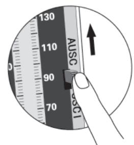
1. اضبط محدد الوضع عند الوضع العلوي (AUSC) لتحديد طريقة القياس بالتسمُّع.
