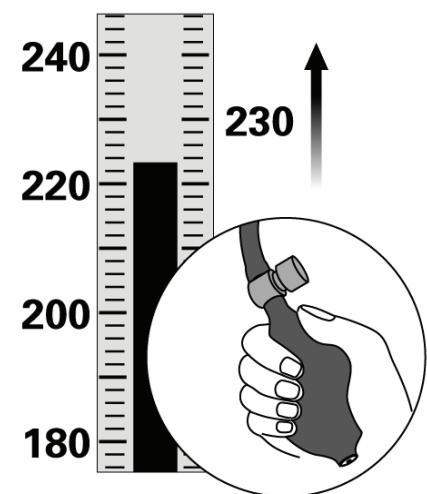
4. Schließen Sie das Entlüftungsventil und beginnen Sie die Manschette mit der Pumpe aufzupumpen. Sobald die Anzeige einen Wert erreicht, der den normalerweise gemessenen systolischen Blutdruck um rund 2.5~4.0 kPa (18.75~30 mmHg) übersteigt, kann mit dem Pumpen aufgehört werden.
