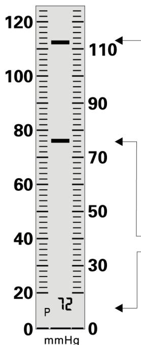
5. Nachdem der Pumpvorgang abgeschlossen ist, öffnet sich das Entlüftungsventil automatisch. Die Luft wird langsam abgelassen und der Druck fällt ab. Das Gerät beginnt den Blutdruck und die Pulsfrequenz automatisch zu messen.
