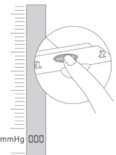
2. اضغط على زر "ON / OFF" بعد سلسلة خطوات بدء التشغيل، وسوف تعرض الشاشة "000" ويكون مقاييس LCD عند الصفر. ويتمتع الجهاز بخاصية التشخيص الذاتي: فعند وجود هواء متبقى في معصم الجهاز، فإن الحرف P يظهر ويومض. بعد التخلص من الهواء المتبقى، سوف يظهر على الشاشة "000".
