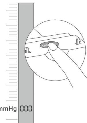
Gerät verfügt über eine Selbsttestfunktion. Wenn das Gerät erkennt, dass sich noch Luft in der Manschette befindet, blinkt der Buchstabe "P" auf. Sobald die Manschette luftleer ist, zeigt das Display "000" an.
