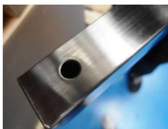
1. Inserire le barre nel supporto di fissaggio centrale mantenendo il foro verso il basso. Si consiglia di collocare tutte e 5 le barre prima di procedere alla fase successiva. Quando tutte le barre saranno in posizione, inserire le viti, stringerle, non fino in fondo, quando tutte le barre saranno ben fissate, serrare bene le viti.
