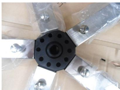
2. Per l'inserimento dell'asta, si deve procedere togliendo la vite collocata sul fondo della stessa, inserire l'asta e fissarla al perno centrale, assicurandosi di aver ben stretto la vite di fissaggio
