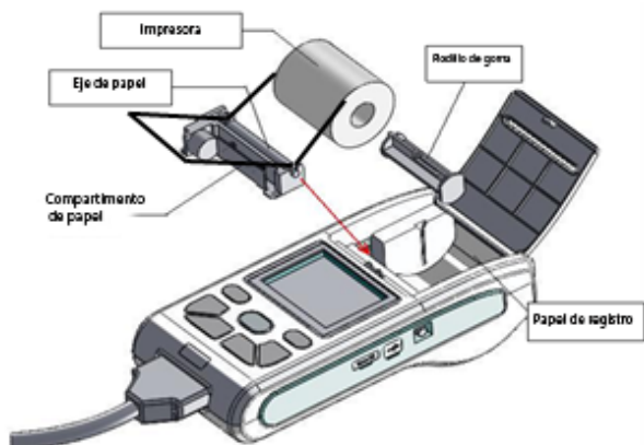
Figura 6-1 Instalación del papel de registro
