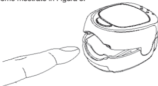
Figura 3 inserire il dito nel saturimetro
