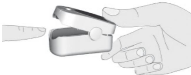
C. El dispositivo se enciende automáticamente al cabo de 2 segundos e inicia la medición.
