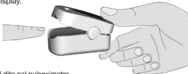
Figura 3: Inserire il dito nel polsoximetro
