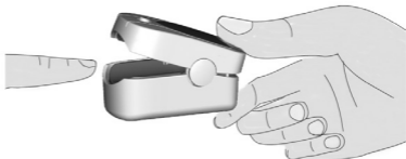
Rysunek 3 Wsunąć palec do osłony
