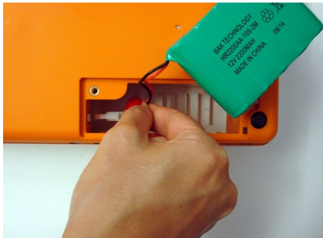
2. Odłączyć gniazdo akumulatora.
