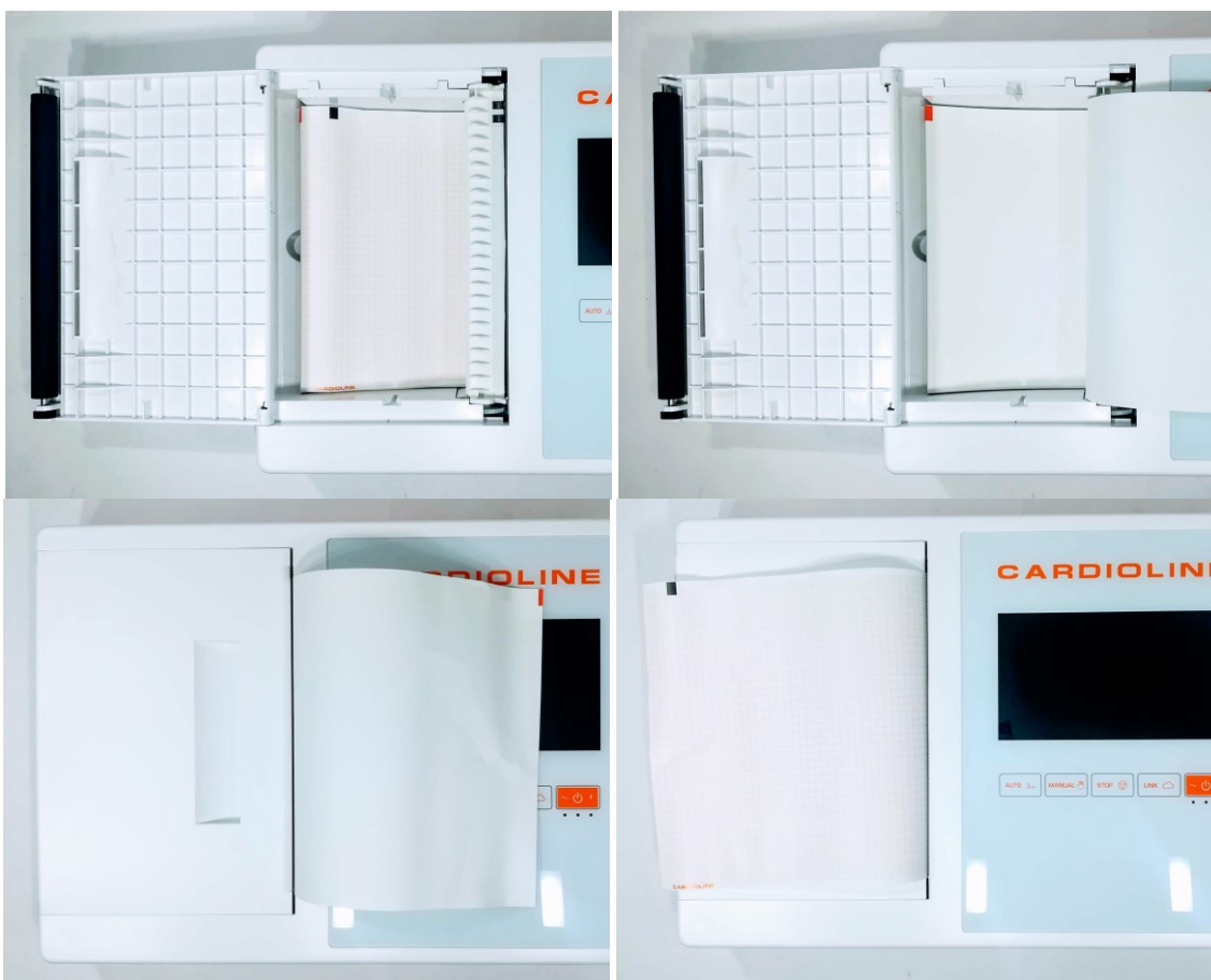
Kolejność czynności w celu załadowania papieru.
