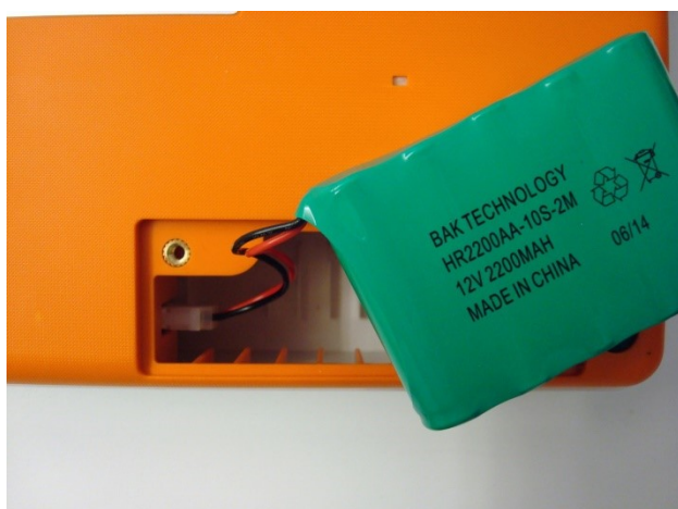
3. Zainstalować nowy akumulator
