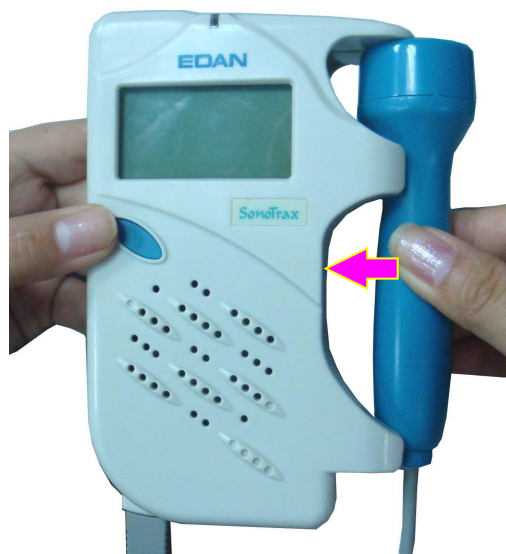
Figura 3-5 Colocação da sonda
