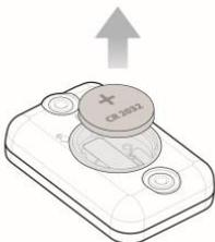
3. Orientar a pilha com o terminal positivo virado para cima, para que se possam ver as letras. Retirar o autocolante de proteção da pilha, se presente
