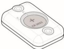
4. Fechar a tampa da pilha; note-se que a tampa da pilha só pode ser inserida numa única direção e deve ser rodada.
