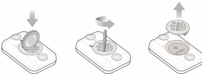
2. Remover a pilha usada e substituí-la por uma pilha nova de 3V CR2032, tipo botão.
