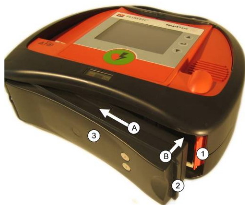
Fig. 10: Colocação do módulo de energia
