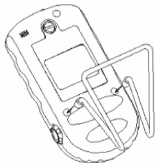
Figura 2-3 Fixação do suporte
