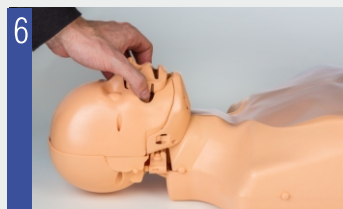
6 Certifique-se de que a válvula está corretamente fixada à cabeça.
