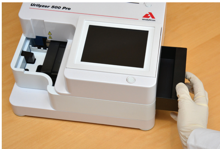
Figura 10: Introducerea tăvii pentru bandelela de testare
