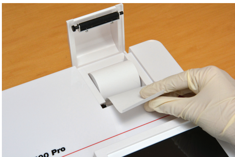
Figura 11: Încărcarea hârtiei pentru imprimantă
