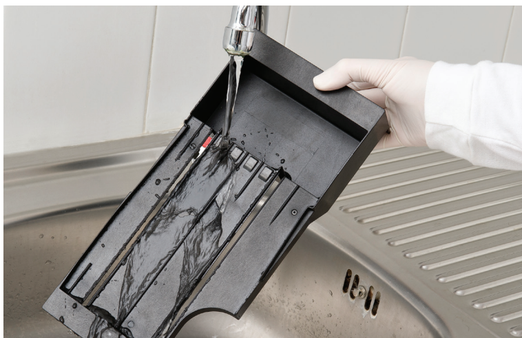
Figura 53: Clătirea tăvii pentru bandelele de testare
