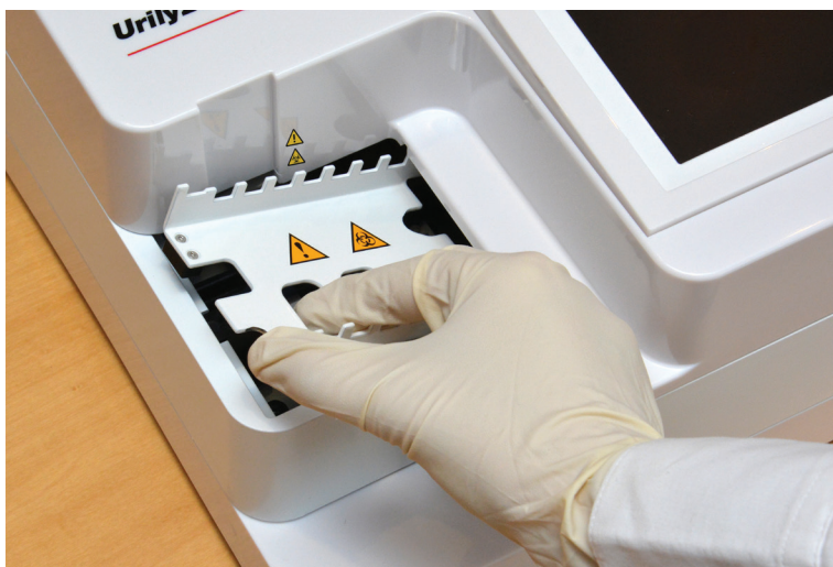
Figura 9: Introducerea greblei temporizatoare a bandetei
