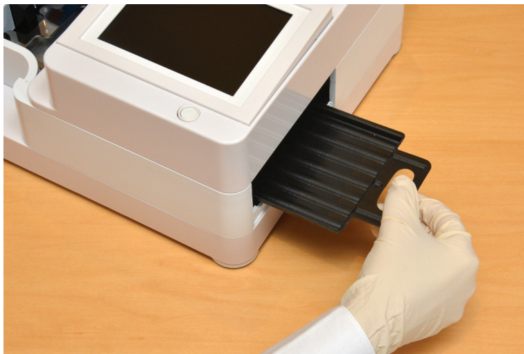
Figura 8: Introducerea tăviței de colectare a picăturilor
