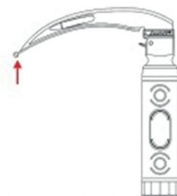
Fig. 3) Ridicați lama în sus până se blochează cu mânerul
