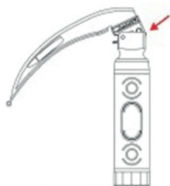
Fig. 2) Prindeți lama cu mânerul aplicând o forță suficientă
