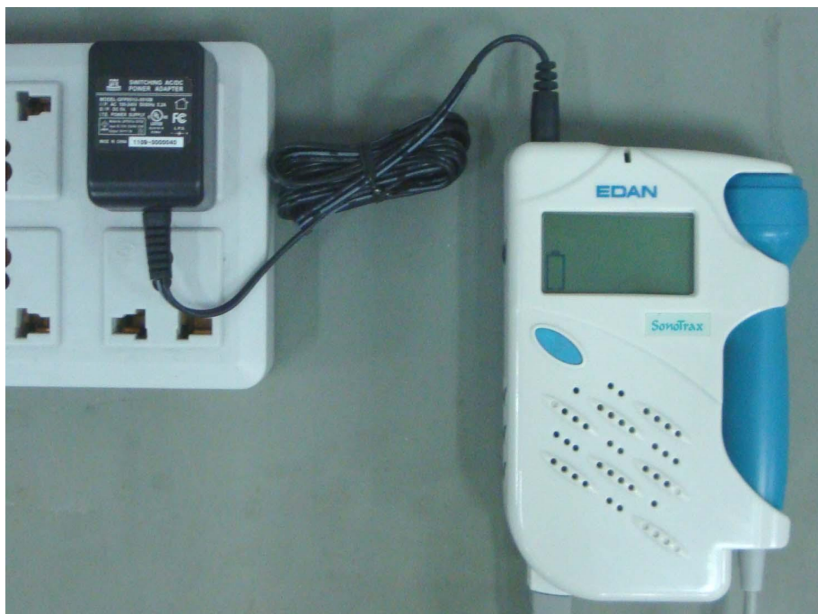
Рисунок 3-7. Зарядка блока никель-металлогидридных аккумуляторов
