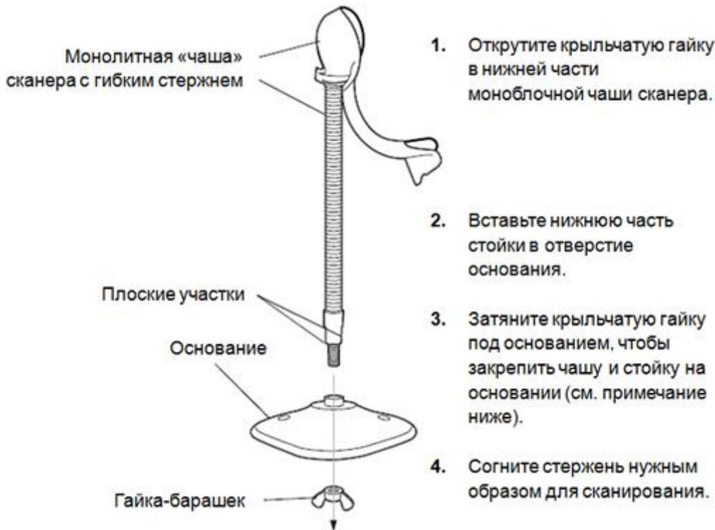
**ПРИМЕЧАНИЕ:** перед затягиванием гайки-барашка под основанием убедитесь в том, что конец гибкого стержня с плоской поверхностью плотно вошел в пазы основания.
