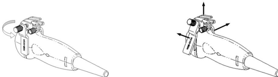
3. Отвинтите контргайку насадки и снимите насадку для биопсии с датчика.
