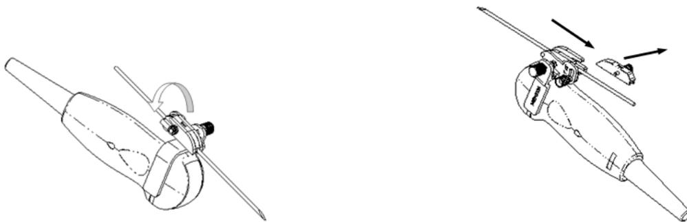
2. Отсоедините остальную часть биопсийной насадки и датчик от иглы.
