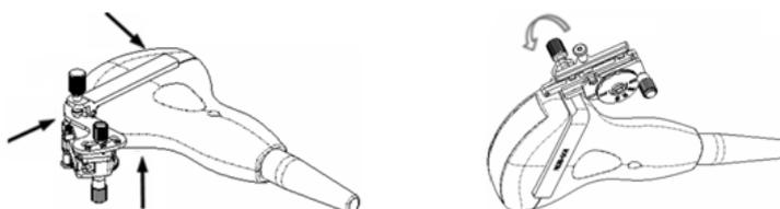
3. Закрутите контргайку биопсийной насадки, чтобы обеспечить ее надлежащую установку на датчике.
