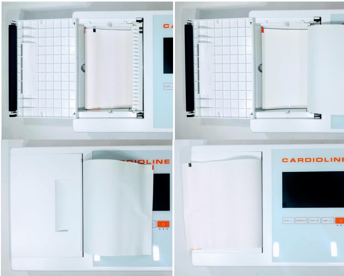
Последовательность действий для загрузки бумаги
