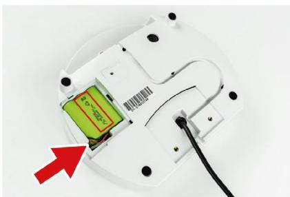
5. Sätt i batteripaketet med texterna uppåt och anslutningskabeln vänd åt vänster. Sätt i batteripaketet först och placera sedan försiktigt kabeln i urtaget längst ner
