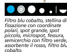
Con filtro verde assorbente il rosso: Filtro blu cobalto, stellina di fissazione con coordinate polari, spot grande, spot piccolo, microspot, fessura, semicerchio con filtro verde, assorbente il rosso, filtro blu cobalto.
