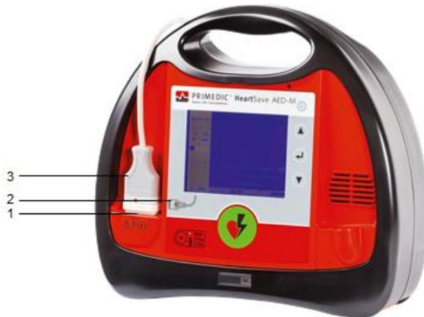
**Fig. 17: Insertar los conectores de los electrodos**
