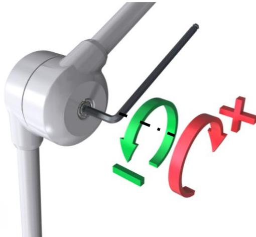
Rimuovere l'adesivo per accedere allo snodo interessato. Utilizzando una chiave esagonale, agire sulla vite di regolazione posta a lato dello snodo.
