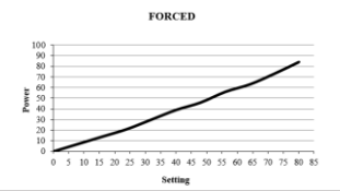
Diagramma della Potenza di uscita FORCED sul carico nominale
