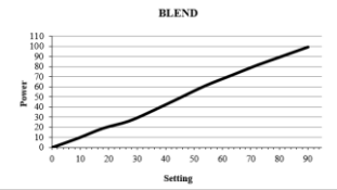
Diagramma della Potenza di uscita BLEND sul carico nominale
