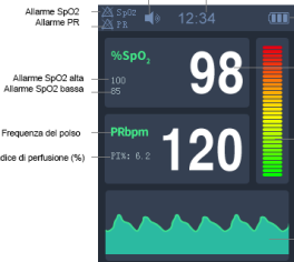
Figura 4. Interfaccia di misurazione
