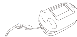
Figura 4 Montaggio del cordino di supporto
