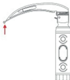
Εικ 3) Σηκώστε τη λεπίδα προς τα επάνω μέχρι να κουμπώσει στη λαβή
