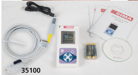
35100 Fornito con sensore adulti, 2 batterie AA, cavo USB, software PC (GB, FR, IT, ES, DE, RU, PL) e manuale d'uso (GB, FR, IT, ES)
